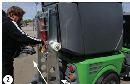
2 Baje la tolva en el bastidor con el portacargas del trinquete
