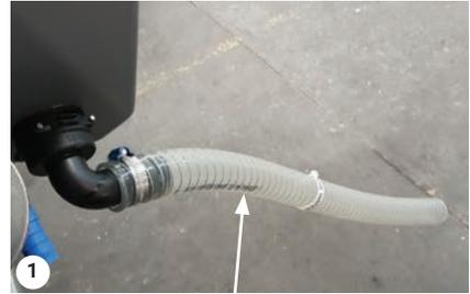
Manguera de nivel de agua del depósito de desperdicios
