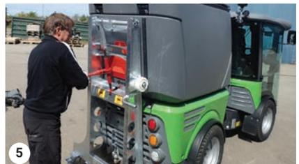
Empuje el bastidor del accesorio y asegúrese de que los ganchos estén en su lugar en los dispositivos de elevación.
