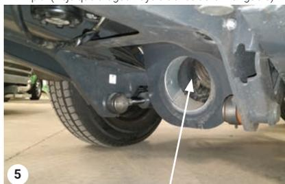
Limpie el sistema de salida de tubos en el bastidor A de la máquina
