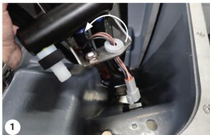
1 Gírese hacia un lado y tire hacia fuera. Orificio del conector
