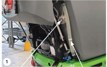
1 Abra el acoplamiento del filtro; llene el agua hasta el mín. de la etiqueta de agua (aprox. 125 L)
