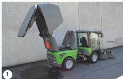
Incline el depósito de desperdicios completamente
