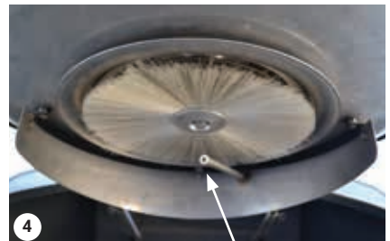
4 Pulverizador de agua en la tolva
