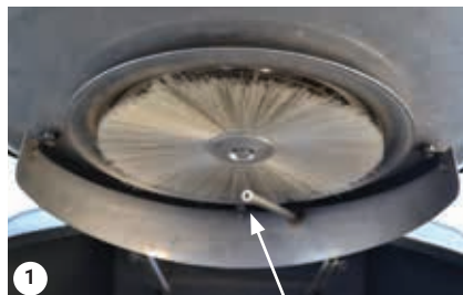
Tubo de pulverización
