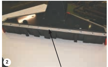
2 Goma delantera Enrosque todos los pernos y cambie la goma
