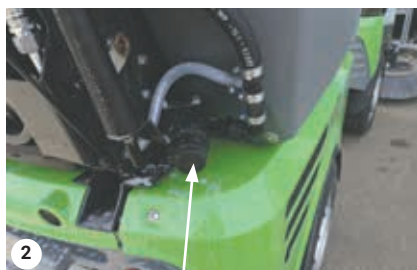
Desenrosque el tapón del filtro
