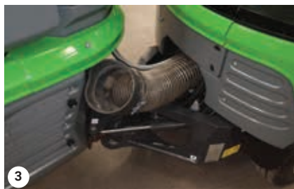
Limpie la manguera en la junta articulada
