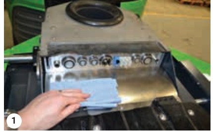
1 Limpie los acoplamientos rápidos con un paño
