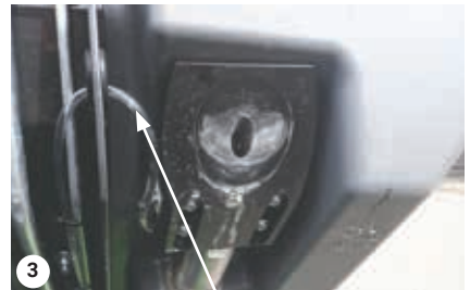
Desmonte la manguera, drene el agua sobrante
