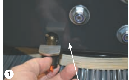
Desenrosque la tuerca de la boquilla
