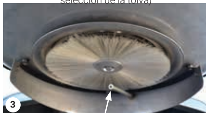
Pulverizador de agua en la tolva
