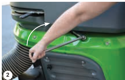
El mango de bloqueo está girado
