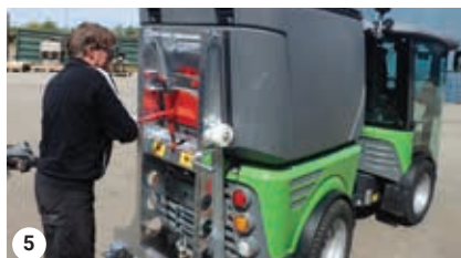
5 Empuje el bastidor del accesorio y asegúrese de que los ganchos estén en su lugar en los dispositivos de elevación.
