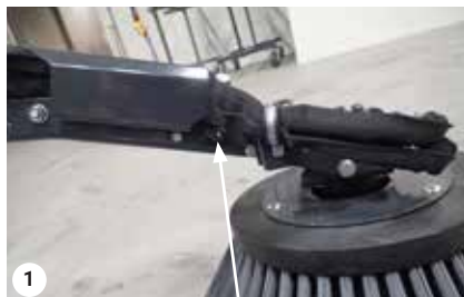
Válvula de agua
