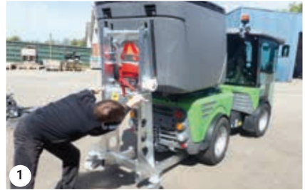
Instalación de la tolva
