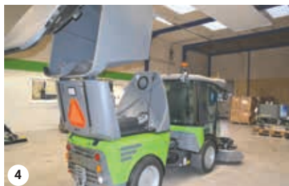
Tolva completamente inclinada
