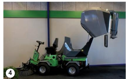
Descarga del colector
