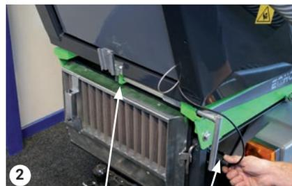
Posición de bloqueo Toma de corriente de 12 V
