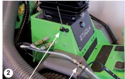
Palanca D Llave de paso de las boquillas pulverizadoras delanteras
