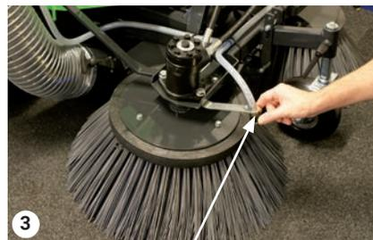
Boquillas pulverizadoras de agua existentes frente a los dos cepillos incluidos de serie
