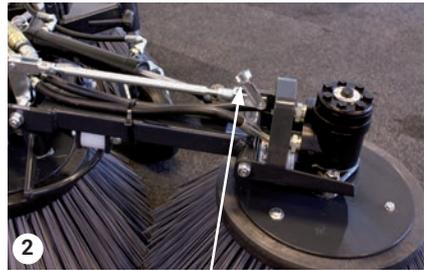
Fíjelo con la sujeción de seguridad
