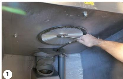
Desmontaje del filtro giratorio
