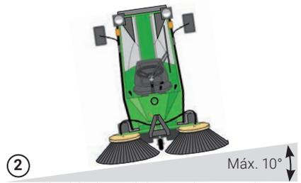
El vehículo no debe conducirse sobre pendientes con una inclinación superior a 10°
