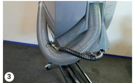
Posición de almacenamiento de las mangueras hidráulicas y de agua
