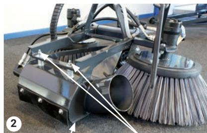
Ajuste de la altura      Pernos de ajuste
