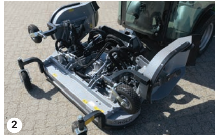
Las cuchillas de las alas levantadas se detendrán automáticamente
