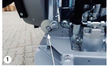
Los bloqueos de transporte deben estar en posición bloqueada
