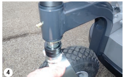
Coloque los anillos espaciadores entre la rueda y la suspensión del cortacésped.
