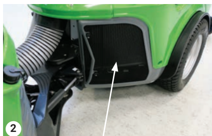
2 Rejilla de refrigeración
