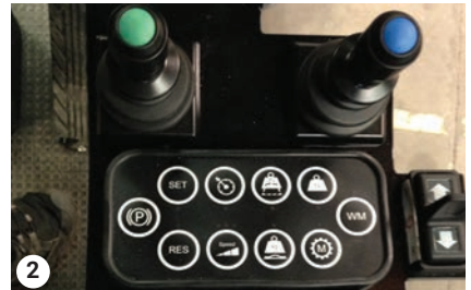
Palanca de mando izquierda - Bajar el cortacésped Palanca de mando derecha - Inclinación del cortacésped
