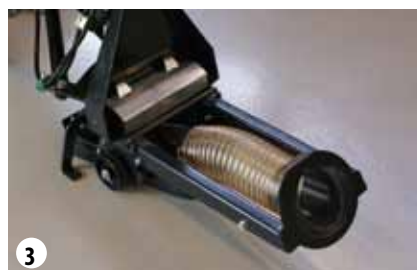
Boca de aspiración montada
