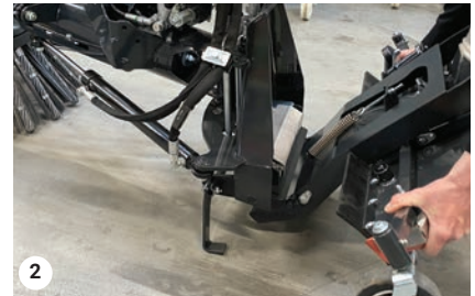
Instalación de la boquilla de aspiración
