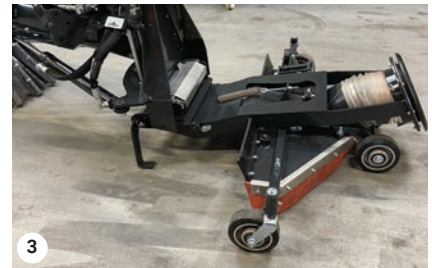
Boquilla de aspiración instalada
