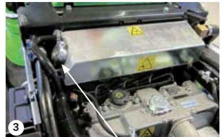
Paisuntasäiliö – tarkasta jäähdytinneste
