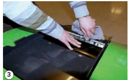
Puhdista pikaliittimet – takakiinnitysteline
