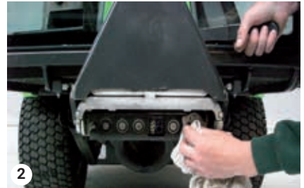
Puhdista pikaliittimet – etukiinnitysteline
