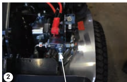
Hinausventtiili on suljetussa asennossa
