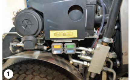
60 A JF15 generaattori - 60 A JF1 syöttö sulakerasia 20 A JF2 hätälinja - 30 A JF3 moottorin teho
