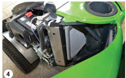
4 Puhdista jäähdyttimet paineilmalla
