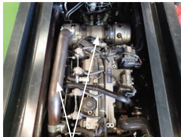
Pakoputkilinja ja D.O.C (diesel-hapetuskatalysaattori)
