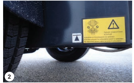
Nivelletyn liitoksen varoitus
