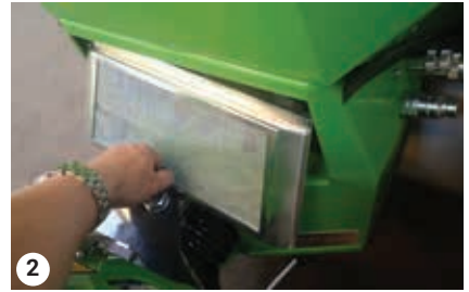
Öljynjäähdyttimen kannen asennus
