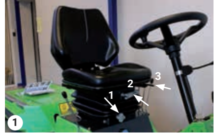
Kuljettajan istuimen säätövivut
