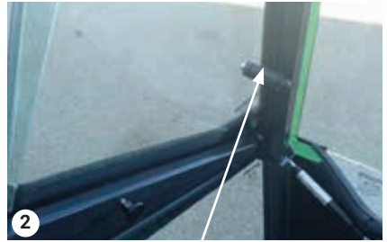
Ikkuna avautuu vetämällä kahvaa taaksepäin
