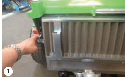
Jäähdyttimen kannen poisto
