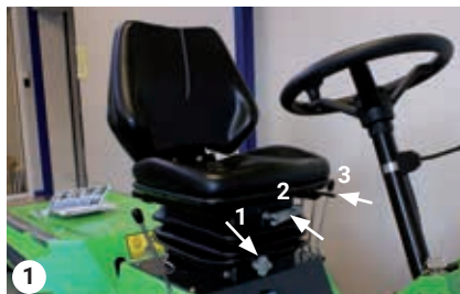
Kuljettajan istuimen säätövivut
