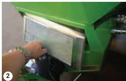
Öljynjäähdyttimen kannen asennus
