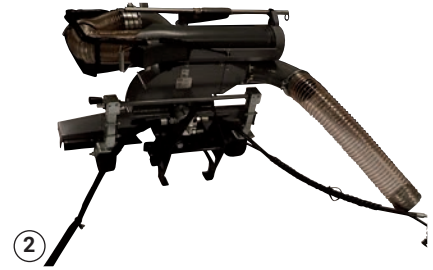
Levitä imuletku ja hydrauliletkut ulos sivuille ennen kiinnittämistä
