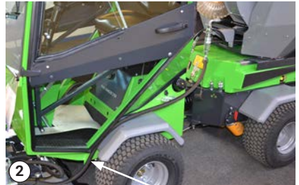
Oikein kiinnitetyt hydrauliletkut – vasen puoli
