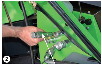
Öljyn ylivuotoletkut D-3-liittimessä
