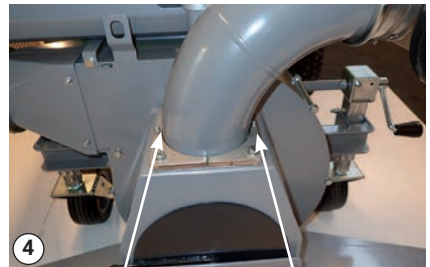
Pyörivän putken voitelu
