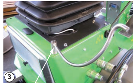
Asenna letkun ripustin kierretappiin istuimen oikealle puolelle
