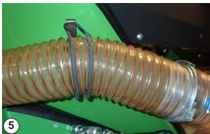
Imuletkun kiinnitys kuminauhalla koneisiin, joissa on ohjaamo
