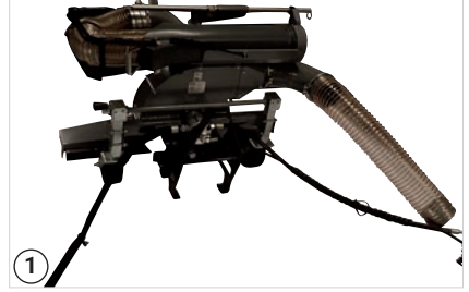
Levitä imuletku ja hydrauliletkut syrjään ennen yhdistämistä
