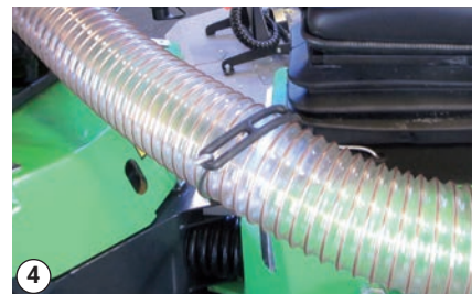
Imuletkun kiinnitys kuminauhalla koneisiin, joissa ei ole ohjaamo
