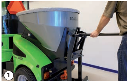
Suola- ja hiekkalevitintä lasketaan koneen päälle
