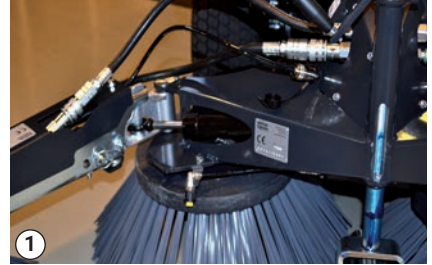
Etukiinnitystelineen hydrauliletkut ja vesiletkut kiinnitetään
