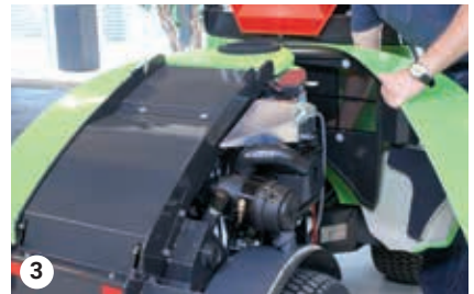
Démontage des protections latérales
