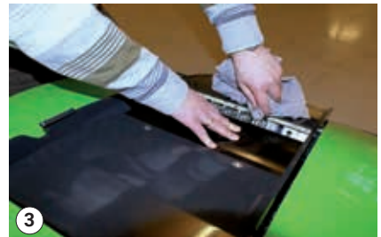
3 Nettoyage des coupleurs rapides – Bâti B
