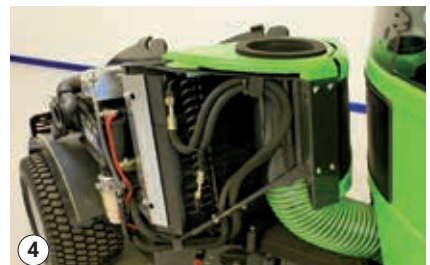
4 Nettoyage des radiateurs à l'air comprimé
