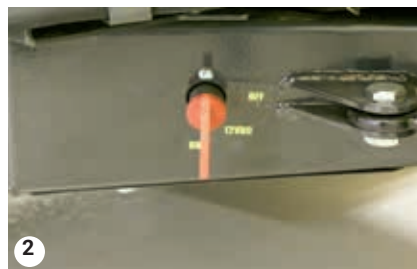
Interrupteur principal – ON
