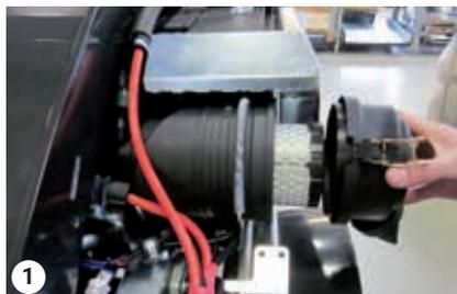
Boîtier du filtre à air / élément du filtre
