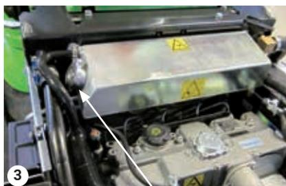
Récipient d'expansion – contrôle du liquide de refroidissement
