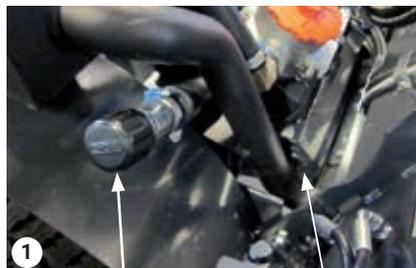
Bouchon de remplissage    Huile hydraulique – jauge en verre
