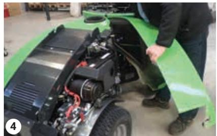
Dépose de la protection latérale
