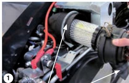
Boîtier du filtre à air      Soupape d'aspiration
