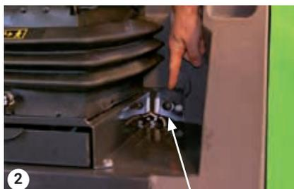
Poignée pour le clapet d'aération
