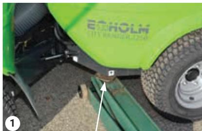
Point de levage, roue arrière
