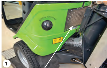
Filtre de la cabine derrière la grille
