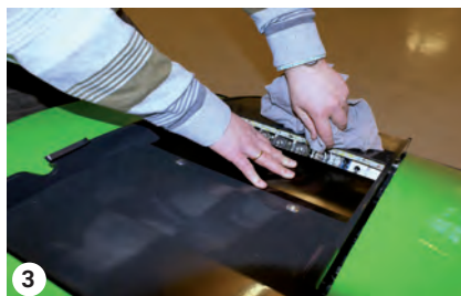
Nettoyage des coupleurs rapides – Bâti B
