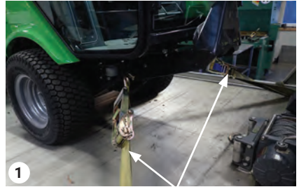
Ancrage à l'avant
