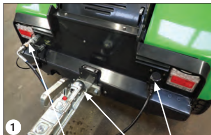
Branchement hydraulique Accouplement Fiche pour les feux
