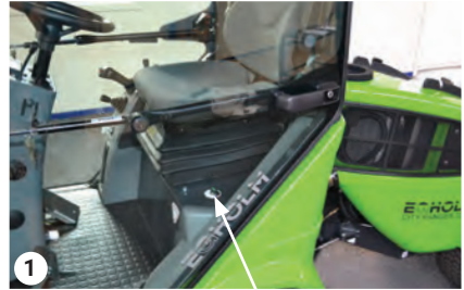
Réglage du chauffage
