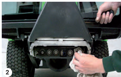
Nettoyage des coupleurs rapides – Bâti A
