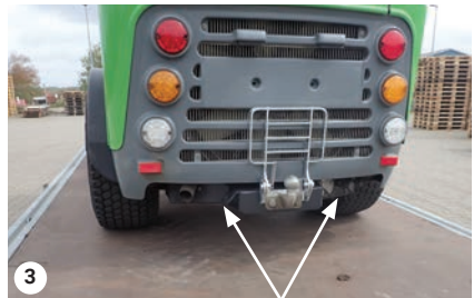
Ancrage à l'arrière, deux supports d'ancrage
