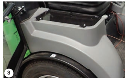
3 Boîte de rangement (avec possibilité de refroidissement)
