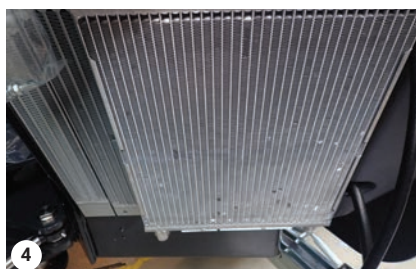
Condenseur de climatisation
