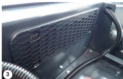
Filtre de recirculation derrière le siège
