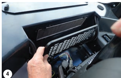
Filtre de recirculation derrière le siège
