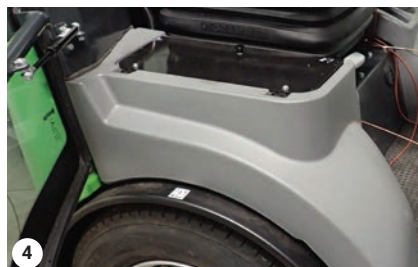
Boîte de rangement (avec possibilité de refroidissement)
