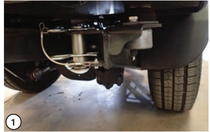
Ancrage à l'avant
