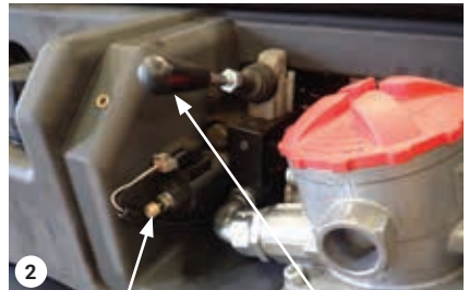
Soupape de pompe hydraulique
