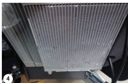
Condenseur de climatisation
