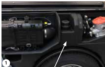
Réservoir de liquide de refroidissement
