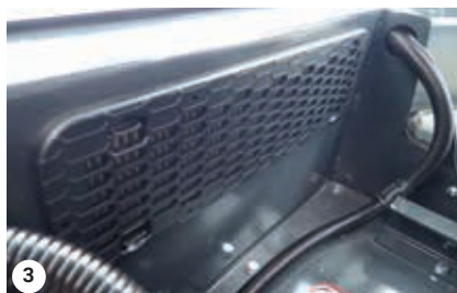
Filtre de recirculation derrière le siège
