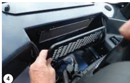
Filtre de recirculation derrière le siège
