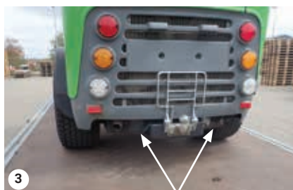
Ancrage à l'arrière, deux supports d'ancrage
