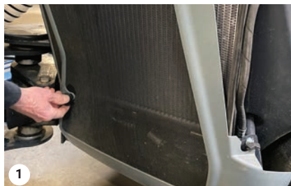
1 Accès au radiateur et au condenseur de climatisation
