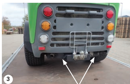
Ancrage à l'arrière, deux supports d'ancrage
