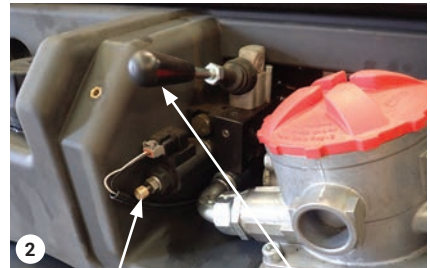
Soupape de pompe hydraulique
