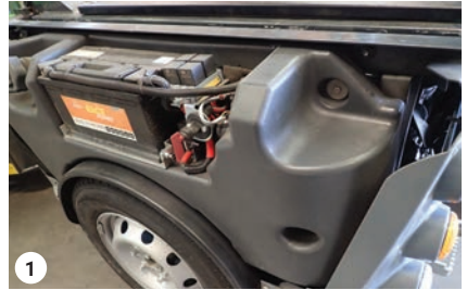
Compartiment de la batterie
