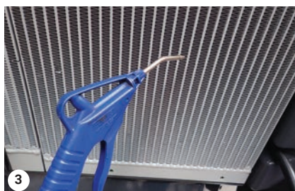
3 Pulvériser le radiateur à l'air comprimé
