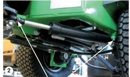
Graisseurs cylindres de commande
