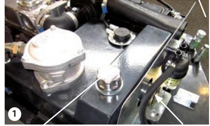
1 Bouchon de dégazage et de remplissage
