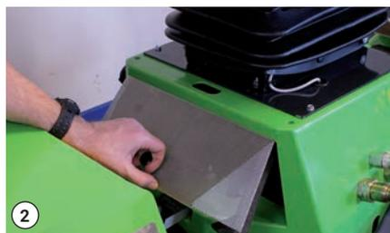
Montage de la protection du réservoir d'huile
