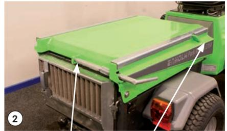
2 Œillet de verrouillage Équerre de verrouillage
