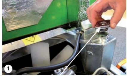
Bouchon pour liquide de refroidissement, récipient d'expansion
