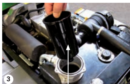
3 Logement filtre réservoir
