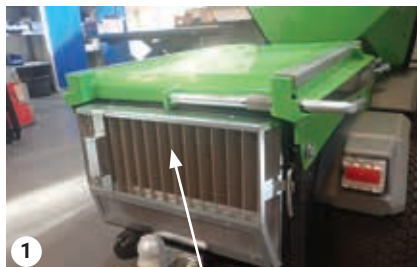
Protection du radiateur d'eau
