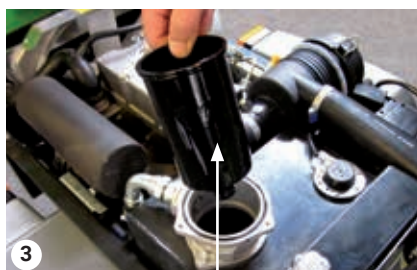
Logement filtre réservoir
