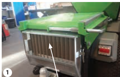
Protection du radiateur d'eau
