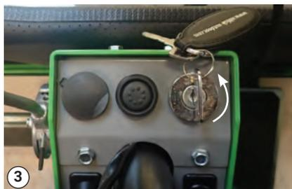
Position d'arrêt, Sens contraire des aiguilles d'une montre.
