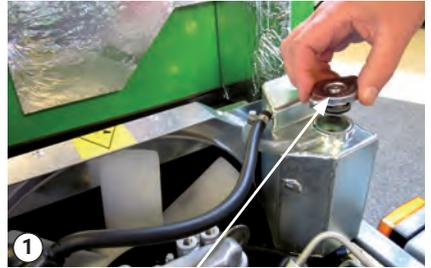
Bouchon du réservoir d'expansion du liquide de refroidissement
