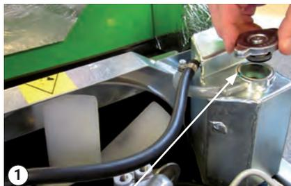
Contrôle du liquide de refroidissement
