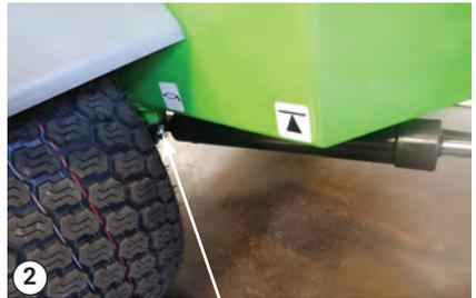
Lubrification des graisseurs, vérins de direction
