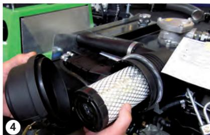
Déposez l'élément du filtre à air
