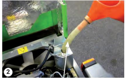
Remplissage avec du liquide de refroidissement
