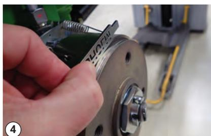
Le boudin de roue doit être à l'extérieur de la clé du capot. Si le boudin est couvert ou presque couvert, le tambour doit être remplacé.
