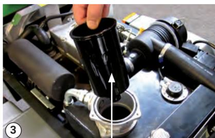
3 Boîtier du filtre de réservoir
