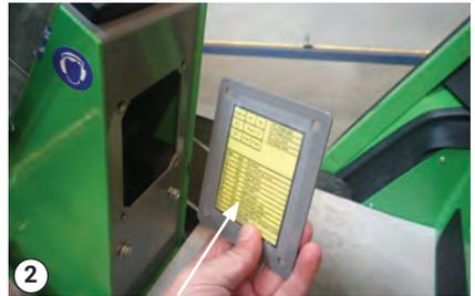
Vue d'ensemble des fusibles - Arrière du couvercle des fusibles
