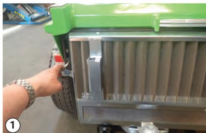
Dépose du capot de radiateur
