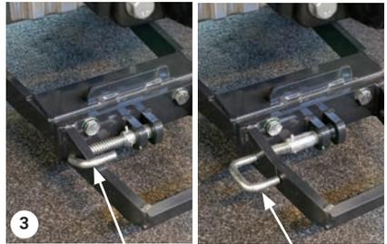
Cliquet d'arrêt verrouillé Cliquet d'arrêt déverrouillé
