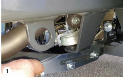
Déverrouiller l'élévateur arrière
