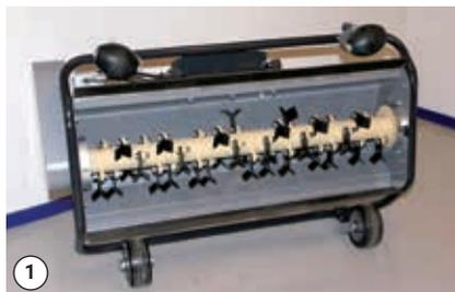
Dispositif de coupe basculé en avant
