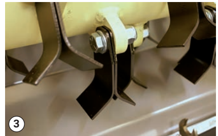
Les hacheurs sont montés ensemble
