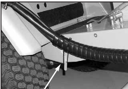
Fixez les tuyaux avec une bride de caoutchouc
