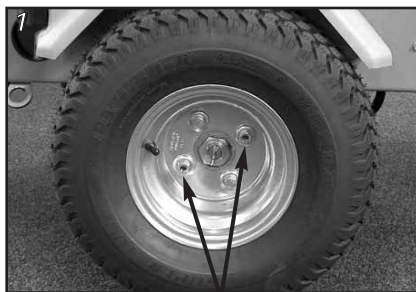
Remplacement des boulons de roues
