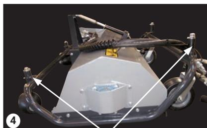
Lubrifiez les fourches de la roue pivotante
