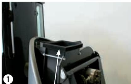
Remplacement du joint sur la turbine d'aspiration
