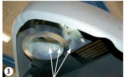
Console, montée avec 3 boulons
