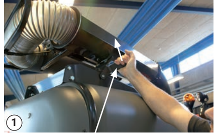
Faites basculer le verrou de transport vers le haut
