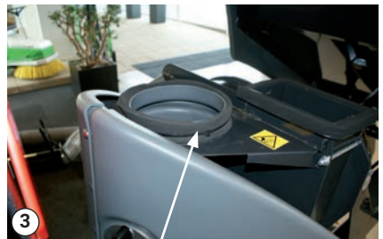
Anneau d'étanchéité fixé avec bandes
