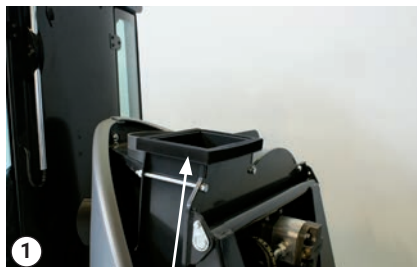
Remplacement du joint sur la turbine d'aspiration
