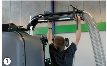
Abaissez dans la bague plastique
