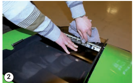
Nettoyage des accouplements
