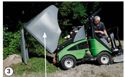
3 Le collecteur d'herbe est entièrement basculé vers l'arrière
