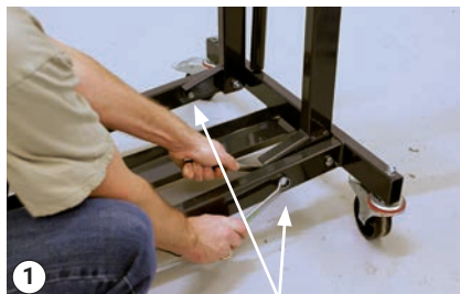
2 boulons sur le support du collecteur d'herbe
