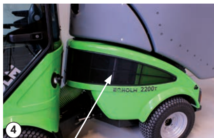
Nettoyage de la grille de radiateur de la machine
