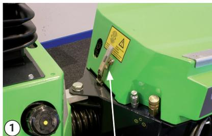
Le loquet du couvercle du moteur doit être engagé !
