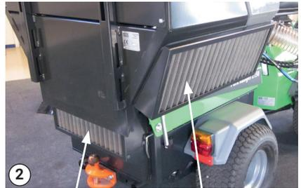
Filtre d'admission d'air latéral Filtre d'admission d'air arrière
