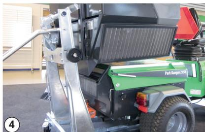
Fixation de la cuve sur la machine
