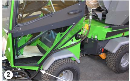
Fixez les tuyaux hydrauliques - côté gauche
