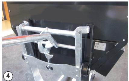
4 Placez la cuve sur la béquille pour l'accrochage/décrochage de la cuve
