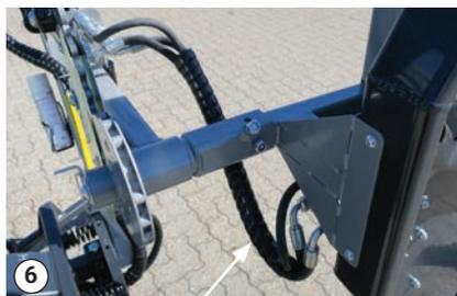
Les tuyaux hydrauliques doivent être guidés sous le tube carré du bras de coupe
