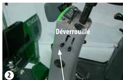
Verrou de transport en position déverrouillée
