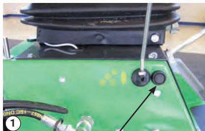
Tlačítko pro ruční aktivaci hadice na sběr listí
