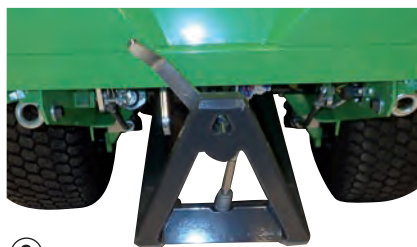
② Pojistná rukojeť rámu A, otevřená
