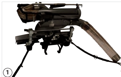
① Před připojováním rozložte sací hadici a hydraulické hadice do stran
