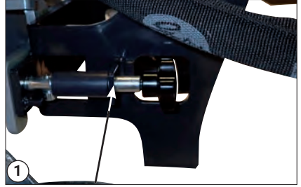
Otevřený pojistný kolík – sací jednotka na listí v plovoucí pozici.
