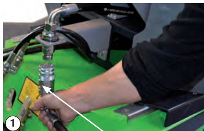
Zpětná hadice ze sací jednotky na listí – s konektorem vnějšího typu
