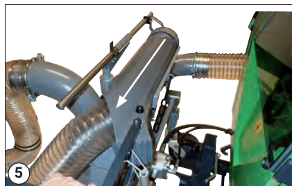
Vyjměte odsávací hubici z držáku
