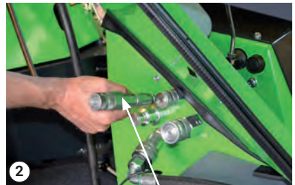
Přepadová olejová hadice na konektoru D-3
