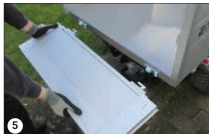
Zadní dveře a boky lze zcela demontovat
