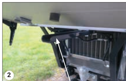
Zadní dveře jsou uzamkykatelná – podpěrné rameno
