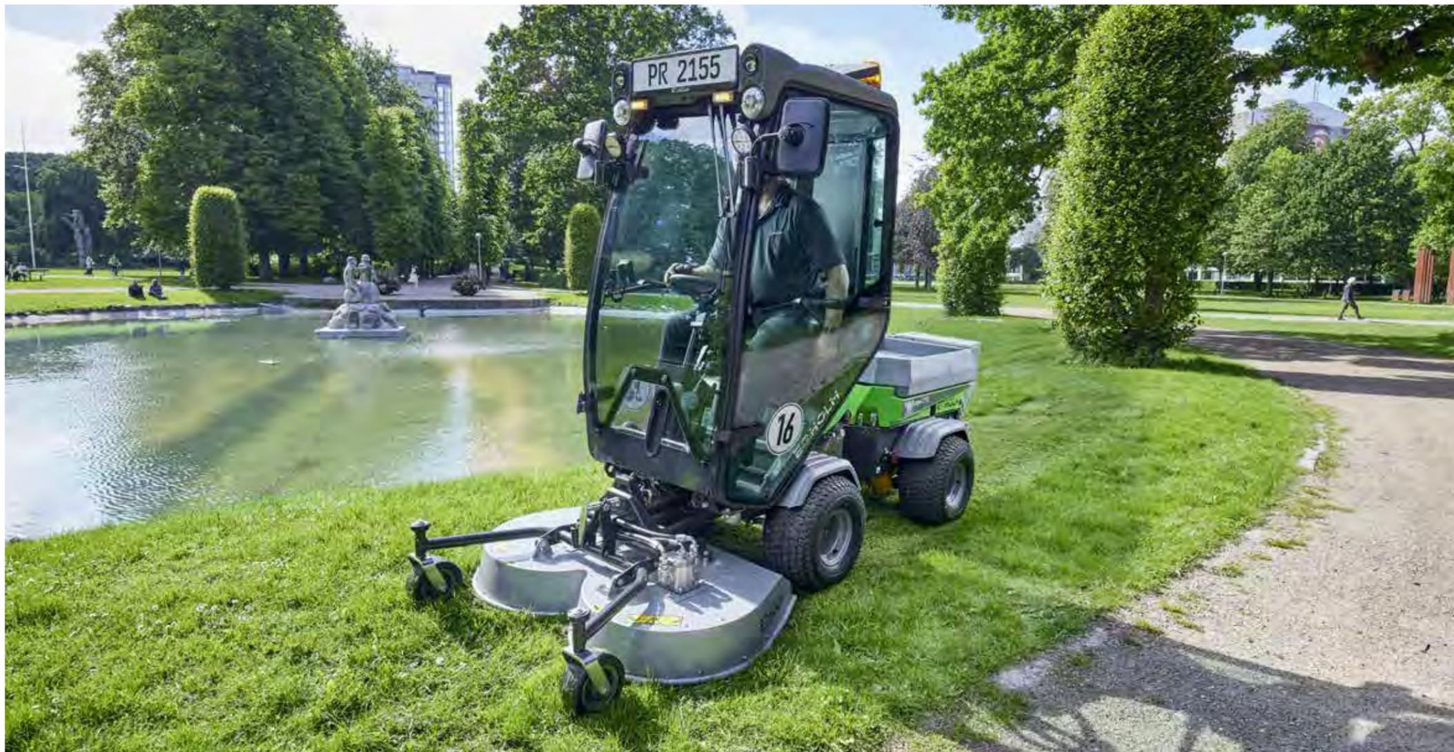
Mit dem Park Ranger 2155 ist der Wechsel von einem Anbaugerät zum anderen in weniger als 4 Minuten bewerkstelligt - ohne Werkzeug!
